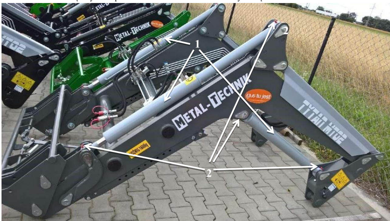
Rys. 8. Lokalizacja smarowniczek: 1- siłownik, 2 –smarowniczka (zdjęcie poglądowe może przedstawiać inny model)
