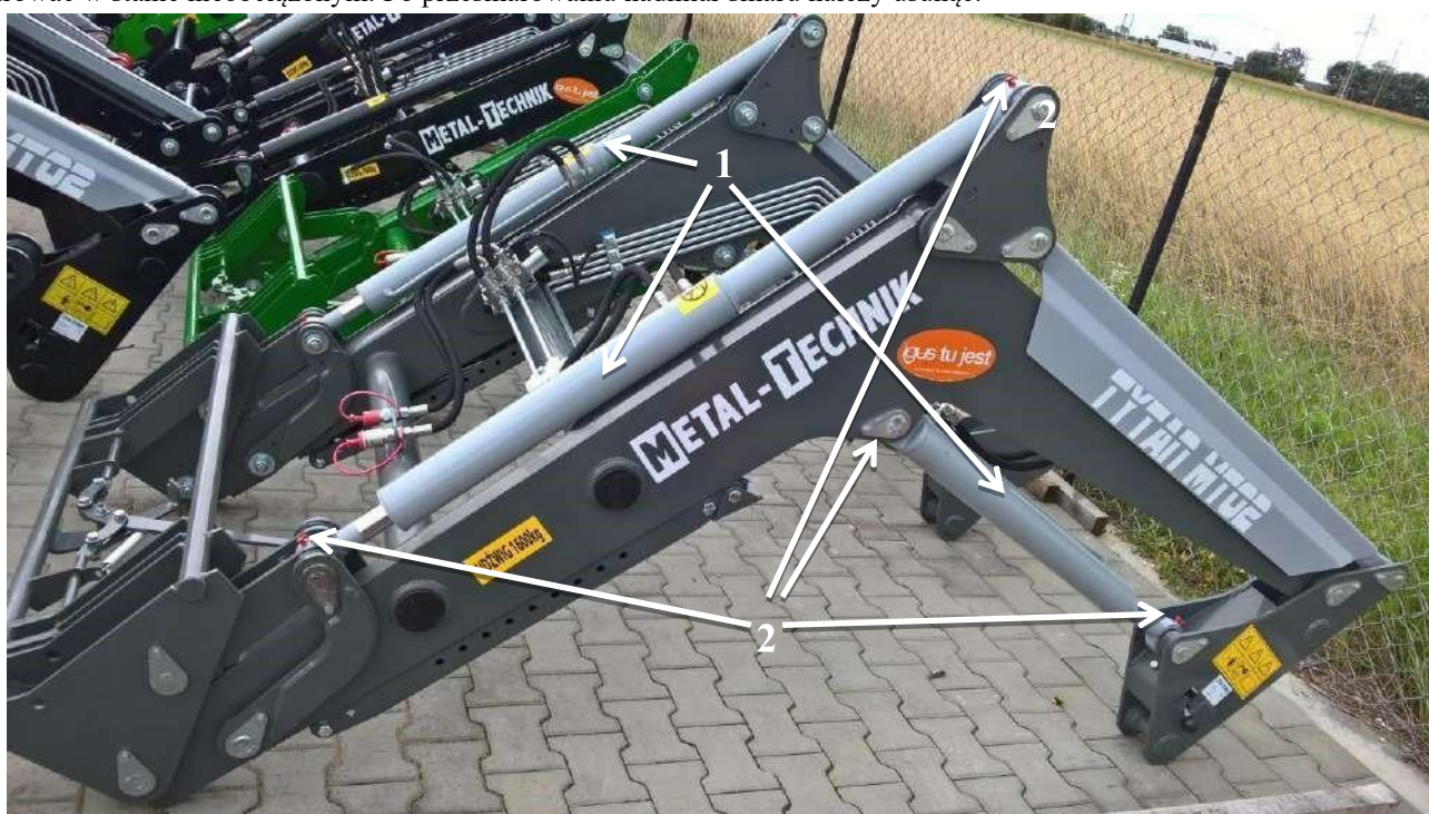
Rys. 8. Lokalizacja smarowniczek: 1- siłownik, 2 –smarowniczka
