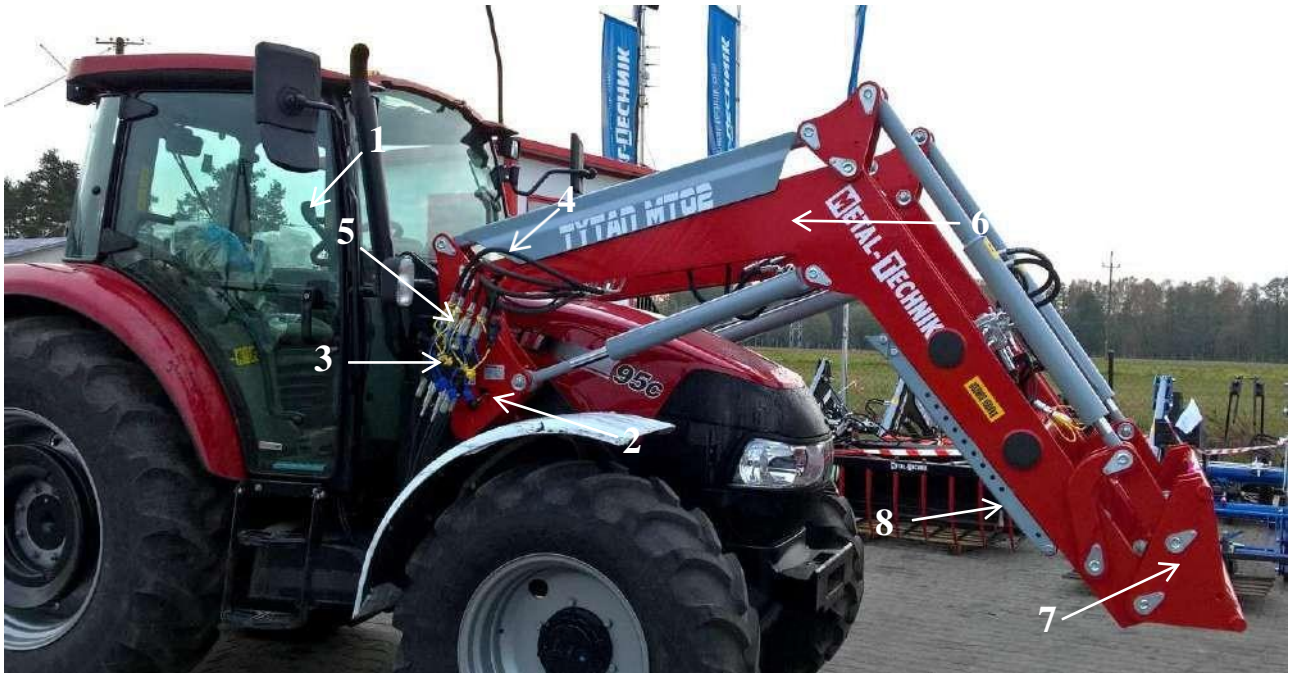
Rys. 5. Budowa ogólna ładowacza: 1-dźwignia sterowania, 2-ryglowanie, 3-rozdzielacz hydrauliczny, 4-przewody giętkie, 5-szybkozłącza, 6-wysięgnik, 7-ramka szybko mocująca, 8-podpora postojowa
