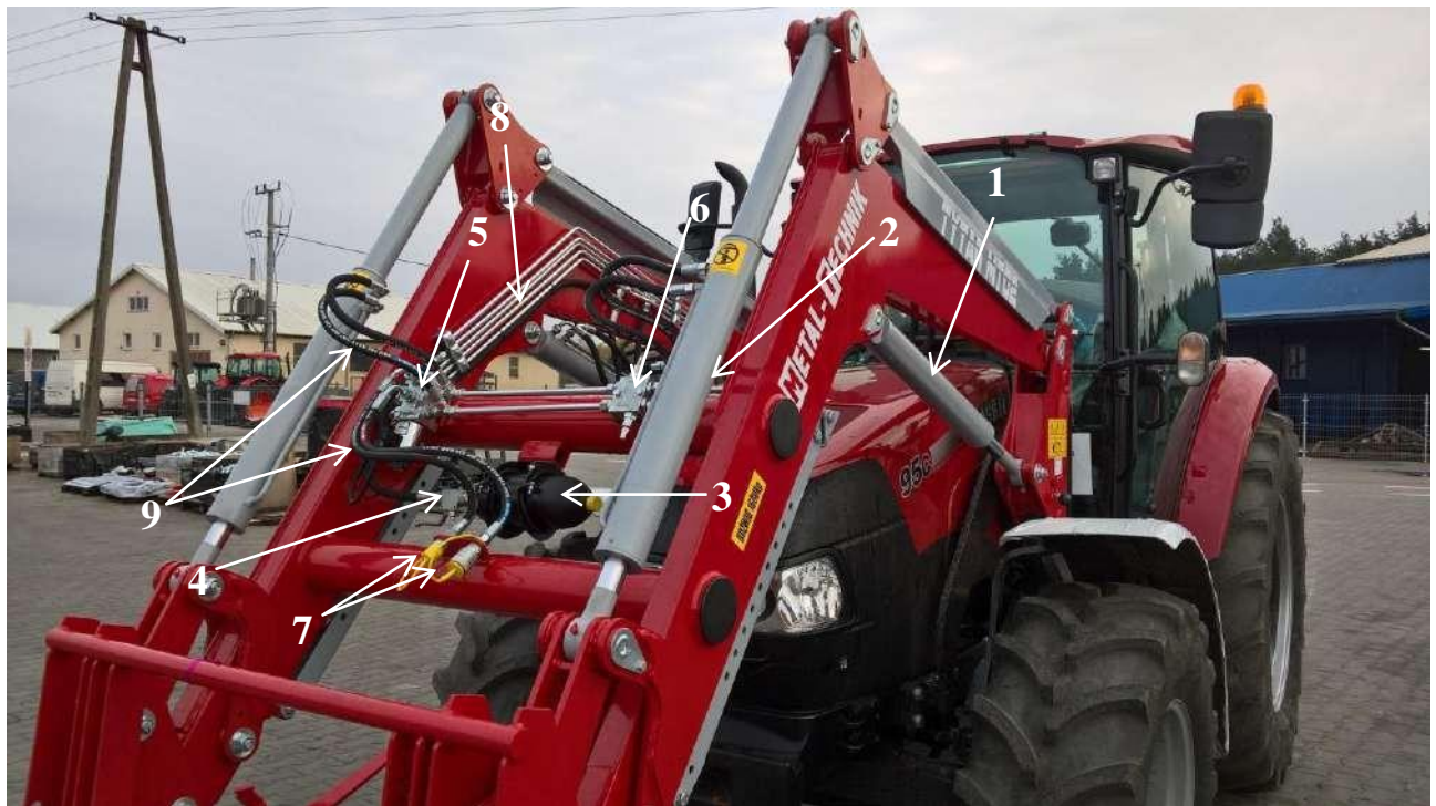
Rys. 6. Budowa instalacji hydraulicznej ładowacza. 1-siłownik hydrauliczny podnoszenia, 2-siłownik hydrauliczny wyciełu, 3-amortyzator, 4-zawór amortyzatora, 5-elektrozawór hydrauliczny osprzętu ładowacza, 6-zawór przelewowy, 7-szybkozłącza zasilania osprzętu, 8-przewody hydrauliczne metalowe, 9-przewody hydrauliczne giętkie.
