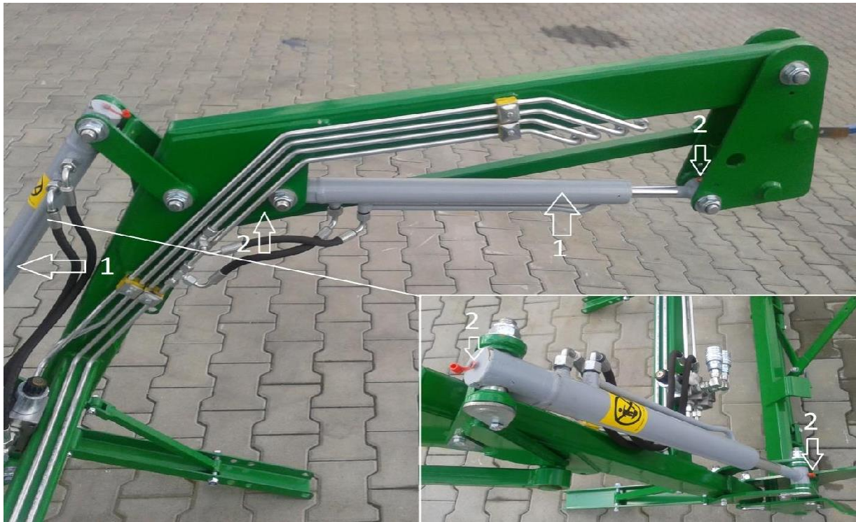
Rys. 3. lokalizacja smarowniczek: 1- siłownik, 2 –smarowniczka
