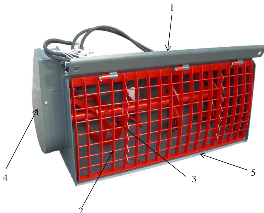
Rys. 1a. Budowa ogólna mieszalnika do betonu: 1- łycha mieszadła, 2-krata zabezpieczająca, 3-ślimak mieszający, 4- przekładnia -, 5-lemiesz,
